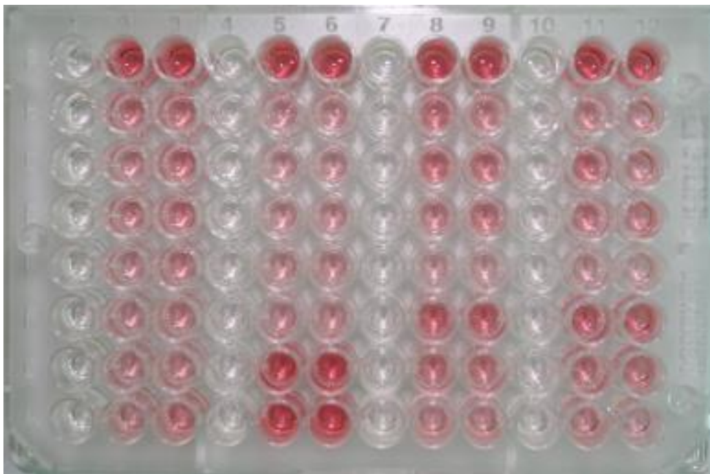
Obr. 3 Plně obsazená 96-ti jamková mikrotitrační destička po barevné reakci. Čtyři bezbarvé sloupce představují slepé vzorky, v horním řádku se střídá voda (slepý vzorek) a dvě glukosové kontroly (100 \mu\text{g/ml} ).
