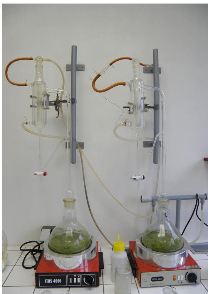
Obrázek 3. Aparatura pro izolaci chmelových silic destilační metodou
